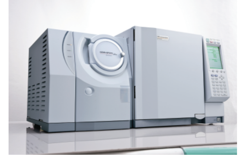
Shimadzu GCMS-QP2010 Gaz Kromatografi Kütle Spektrometre Sistemi yaş meyve-sebzelerde pestisit kalıntı analizleri için ülkemizde de yoğun olarak kullanılıyor
