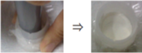
Şekil 8. Manuel sıkıştırma ile toz numune hazırlama prosedürü
