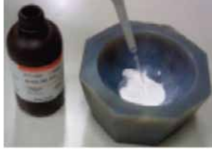
Şekil 3. Standart Çözelti ile karıştırma
