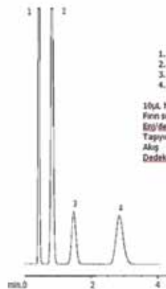
Moleküler Sieve 5A kolon ile GC-TCD kullanılarak yapılan bir gaz analizi örneği
